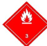
Transporte de líquidos viscosos en embalajes con capacidad inferior a 450 L según 2.2.3.1.5. (ADR) o a 30 L según 2.3.2.5. (IMDG).
